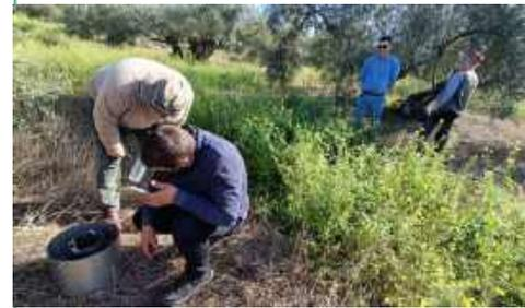
Prueba en campo del infiltrómetro de doble anillo.
