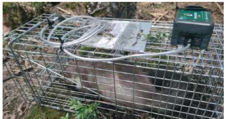
**Fotos 3.** Las jaulas trampa con aviso telemático permiten reducir el tiempo de retención de los animales capturados notablemente.
